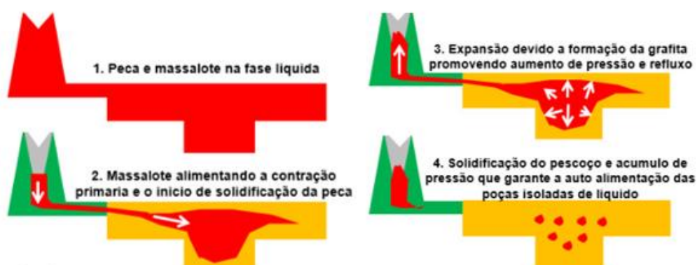
Figura 7 – Etapas de solidificação e ação do massalote em ferros fundidos
